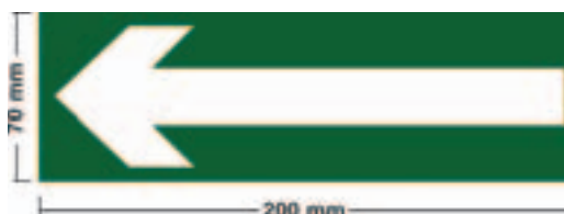
Figura 2 – Detalhe da sinalização tipo C-I
